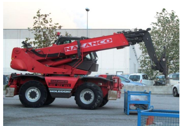
Esempio di Carrello/sollevatore/elevatore semovente telescopico rotativo
