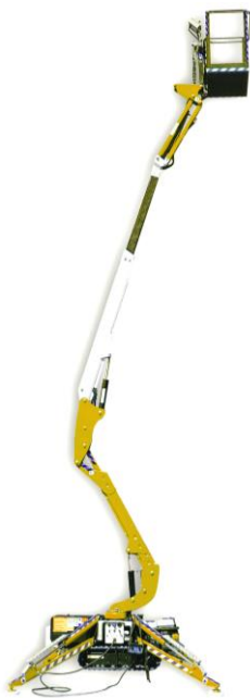
PLE su stabilizzatori
